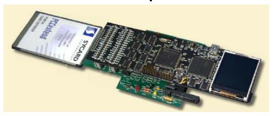
CAM Inspector 是一款高效率隨時的DVB-CI/CI+開發和測試工具,它能偵測主機(HOST)和CAM模組之間的CI介面通訊情況,並且可以模擬任何一方。
